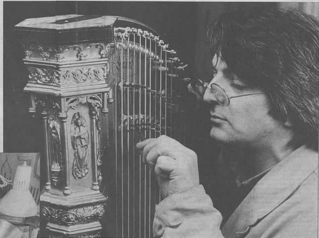
Bis auf den Zehntelmillimeter genau: Die Arbeit eines Harfenbauers erfordert höchste Perfektion. Rainer Thuruu (o.) reguliert die Außenmechanik einer fertig restaurierten Erard-Harfe, Martin Steinhilber (u.) beim Einsetzen der Achsen an eine Harfenmechanik. Foto: Karin Hill
